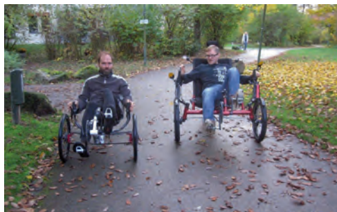
„links das Hi-Trike mit Blattfedern“ – „rechts ein Maßrahmen für einen 200 kg-Fahrer“
