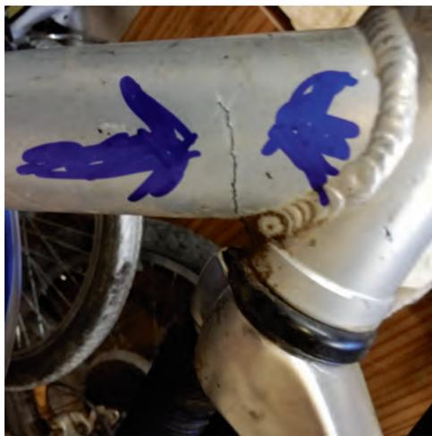
*Typischer Riss im Unterrohr. Durch thermische Veränderungen im Materialgefüge beim Schweißen reißt das Rohr immer neben der Schweißnaht.*
